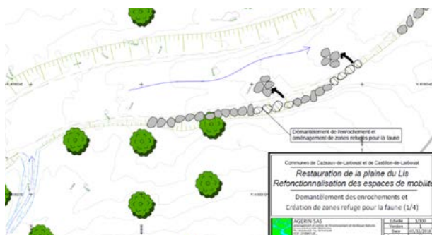
Travaux dans la vallée du Lis (démantèlement d'enrochement pour la restauration de l'espace de mobilité du cours d'eau, source : AGERIN).
